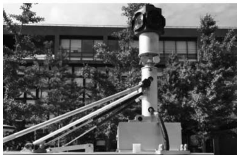
图 5-45 ADAS 地图采集车的摄像头
