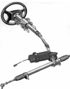
图 2-51 齿轮轴式电动助力转向系统
