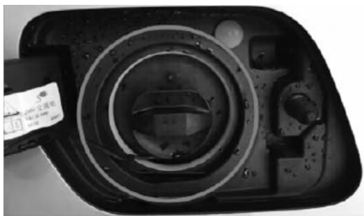
图 4-44 充电接口防潮保护装置
