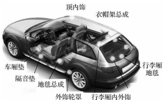
图 4-23 汽车车体结构的黏接部位
