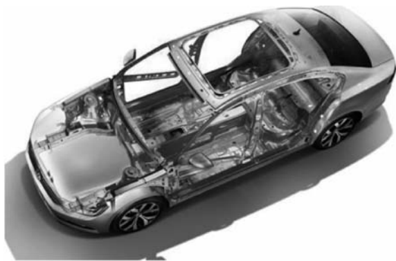
图 4-20 迈腾轿车热成型车身
