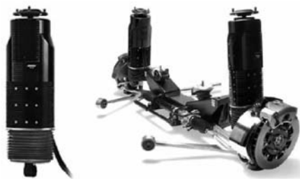
图 4-88 BOSE 公司直线电机式馈能悬架
