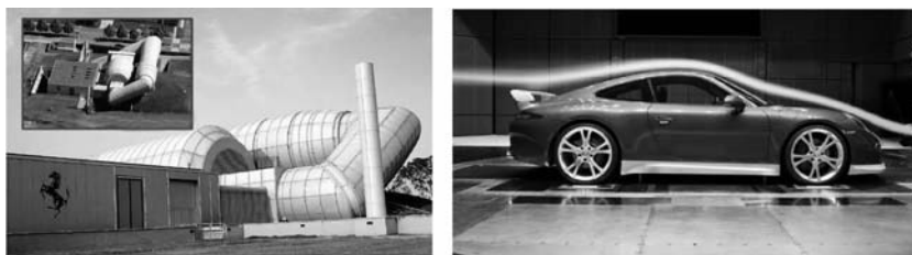
图 4-59 法拉利赛车风洞及赛车试验图
