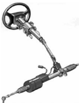
图 2-52 齿条轴式电动助力转向系统
