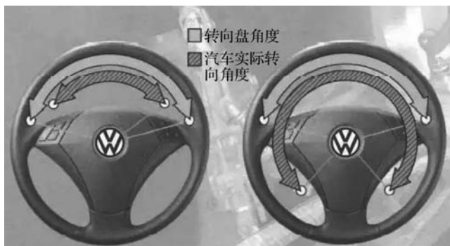
图 2-57 汽车实际转向角度与转向盘转角的关系
