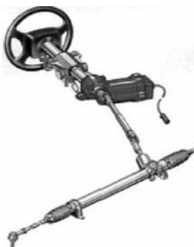
图 2-50 转向轴式电动助力转向系统
