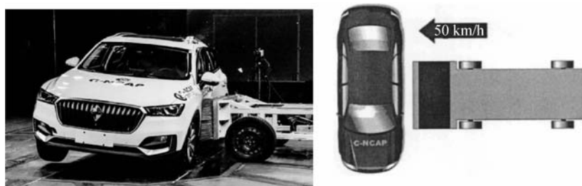
图 3-2 侧面碰撞示意图
