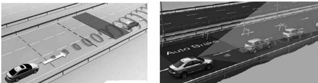
图 3-52 城间自动紧急制动系统
