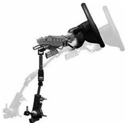
图 3-64 可溃缩式转向柱
