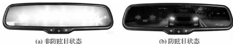
图 3-12 防眩目后视镜的工作状态
