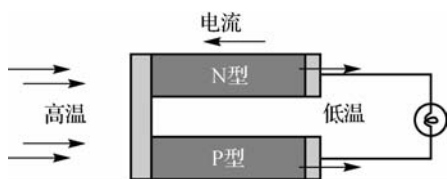
图 4-83 塞贝克效应示意图
