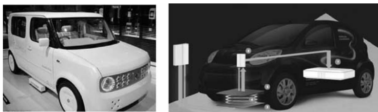
图 4-51 日产魔方电磁感应式无线充电汽车
