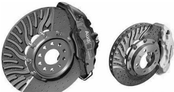
图 2-77 复合陶瓷制动盘
