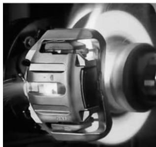
图 4-75 制动产生热量
