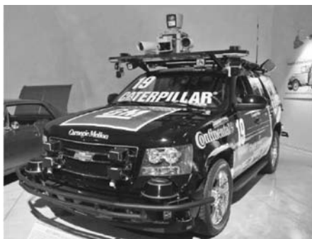
图 5-27 Boss 无人驾驶汽车环境感知传感器
