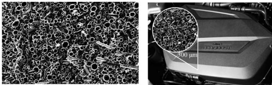
图 4-11 蜂巢结构塑料零部件
