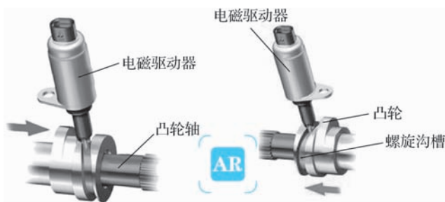
图 1-11 AVS 可变气门升程实现过程
