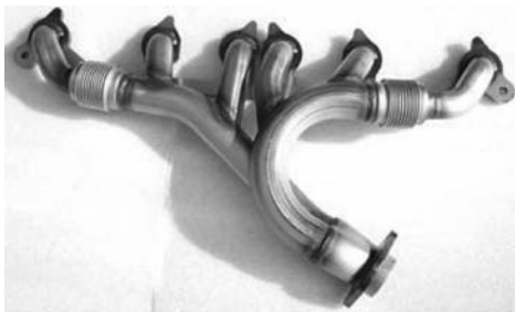
图 4-19 排气管液压成型产品
