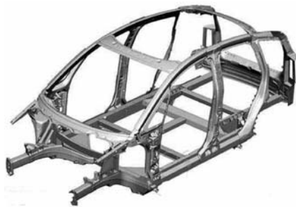
图 4-15 玻璃纤维增强塑料车架
