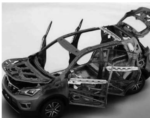
图 4-21 热成型钢板在车身上的应用
