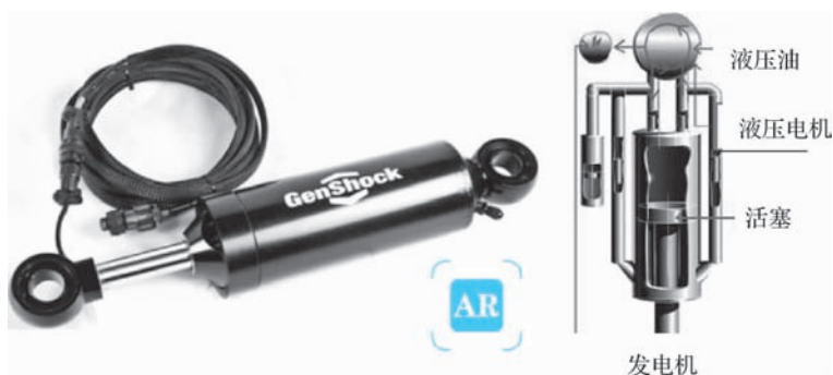
图 4-91 GenShock 馈能悬架及其结构示意图
